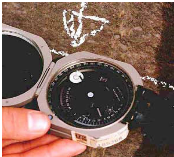
تماس لبه کمپاس با سطح لایه برای بدست آوردن امتداد تراز کروی ( چشم گاوی ) باید تنظیم شود
