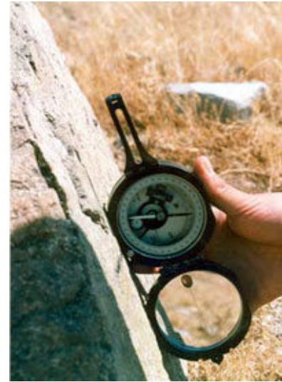
نحوه قرار گیری لبه کمپاس بر روی قرار گیری لبه کمپاس عمود بر امتداد لایه برای بدست آوردن شیب آن لایه برای تعیین مقدار شیب
