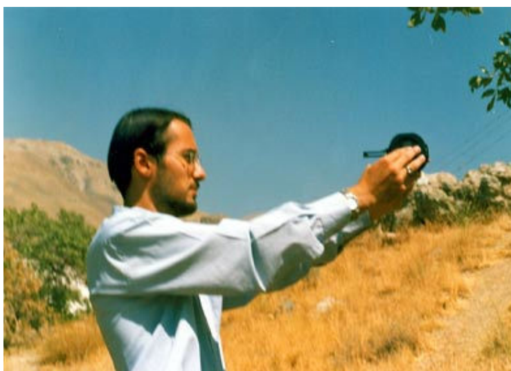
نشانه روی چشمی برای تعیین ارتفاع نقاط نسبت به خود
