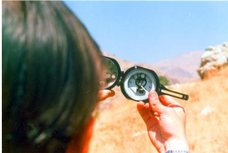
بدست آوردن شیب توپوگرافی از راه دور با نشانه روی چشمی
