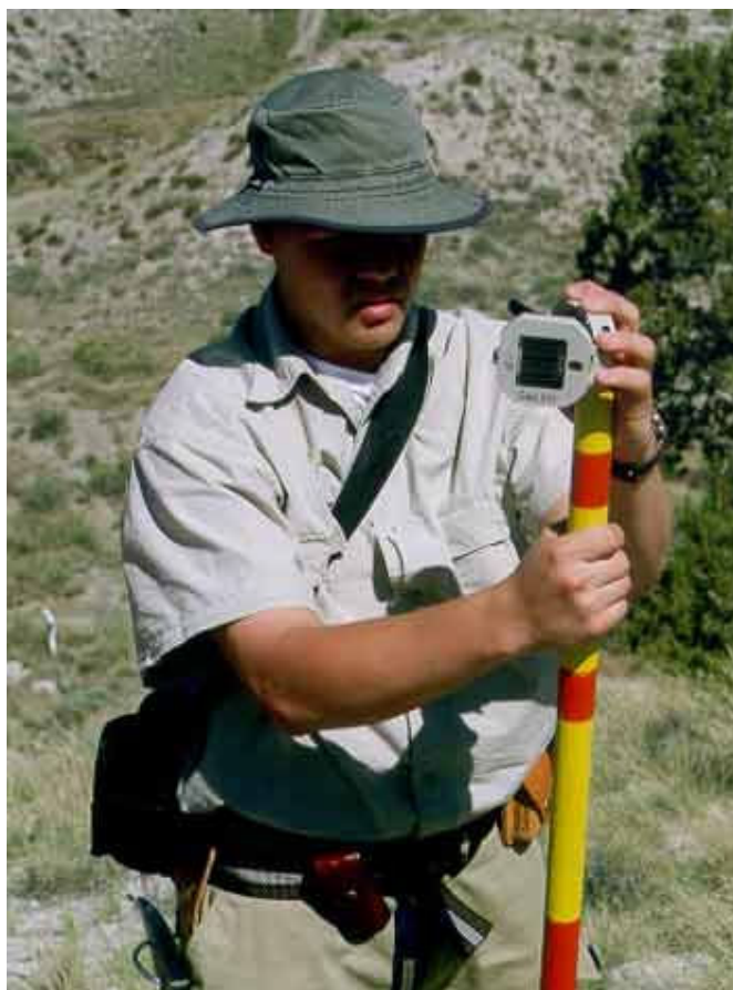
استفاده از پایه نگهدار و کمپاس برای تعیین ضخامت حقیقی لایه ها
