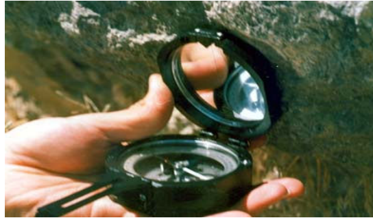
طریقه قرار دادن کمپاس در سطح زیر لایه
