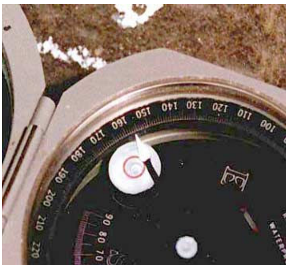
تماس لبه کمپاس با سطح لایه برای بدست آوردن امتداد تراز کروی ( چشم گاوی ) باید تنظیم شود
