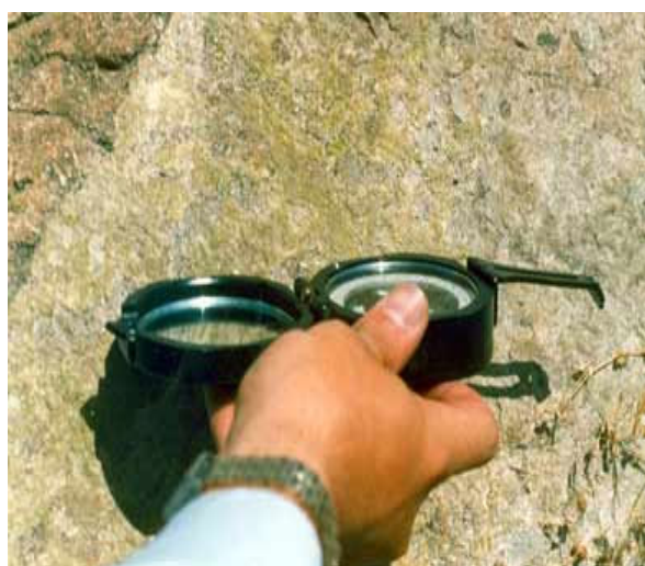
روش مستقیم بدست آوردن امتداد لایه طریقه قرار دادن لبه کمپاس بر روی لایه برای بدست آوردن امتداد لایه
