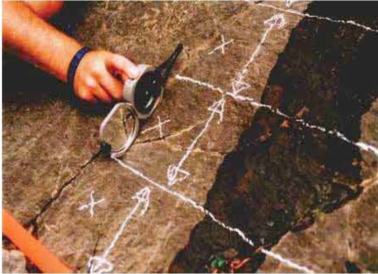
نحوه قرار گیری لبه کمپاس بر روی قرار گیری لبه کمپاس عمود بر امتداد لایه برای بدست آوردن شیب آن لایه برای تعیین مقدار شیب
